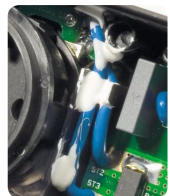
Bild 20: Kabel im Gehäuse mit Klebstoff sichern
