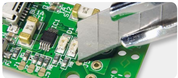
Bild 6: J 5 ist bei angeschlossenem Temperatursensor aufzutrennen.
