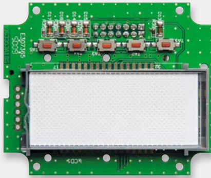
Bild 8: Einsetzen der Licht-Verteilplatte mit dem Punktraster nach unten
