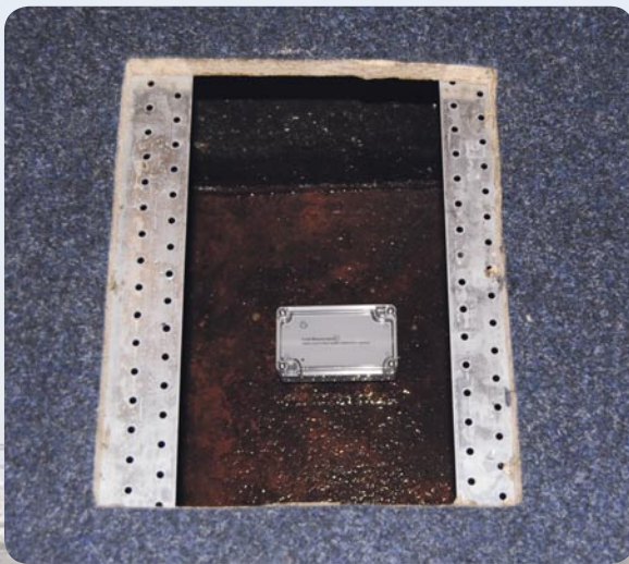
Bild 6: Genau an der richtigen Stelle – Feuchtesensor für die Überwachung der Bilge
